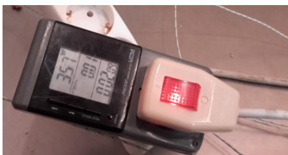
Obr.č.2 – elektromer PM300 s možnosťou odpočtu a zmeny meracích veličín
