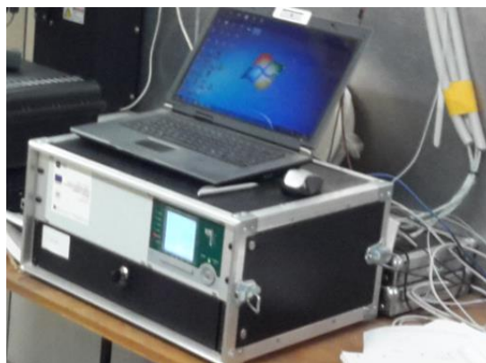
Obr.č.4 – meracia centrála detail a pohľad na pripojenú centrálu v systéme merania s riadiacim počítačom so zápisom dát.
