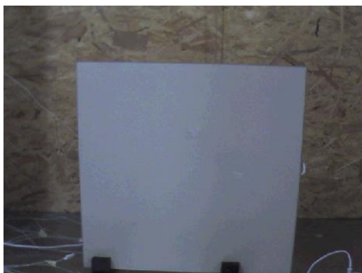
Obr.č.1 – elektrický konvektor = meraná vzorka 600x600x30 mm.
