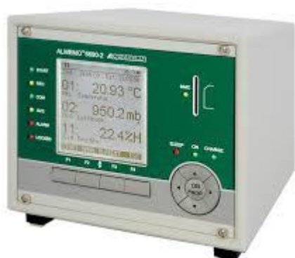
Obr.č.4 – meracia centrála detail a pohľad na pripojenú centrálu v systéme merania s riadiacim počítačom so zápisom dát.
